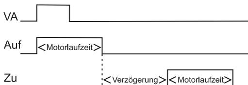
tvu = Umschaltpause (0,6s) zwischen Auf und Zu zum Motorschutz (mechanische Entlastung).
