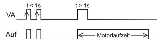
Eingestellter Jalousiegegenlauf (tg): Gegenlauf wird durch Zeitablauf von VZ oder durch manuellen Stopp mit VA bzw. VZ ausgelöst.
