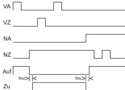
Jalousiemode: Vororteingänge sind bei kurzem Tastendruck pegelgesteuert und bei langem flankengesteuert.
